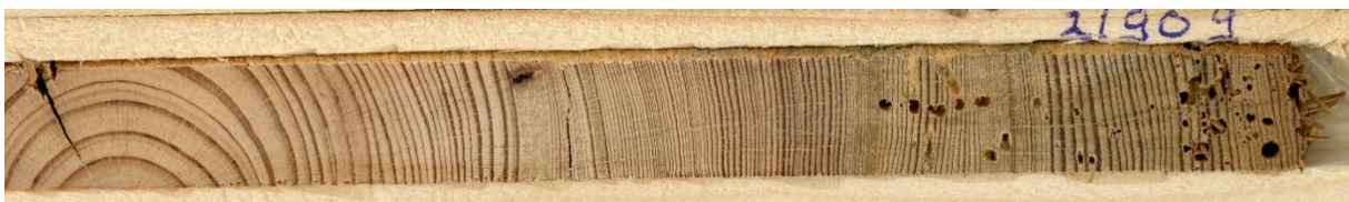
Grenen boorstaal van de voorste balk (straatkant) van de zolderconstructie.
